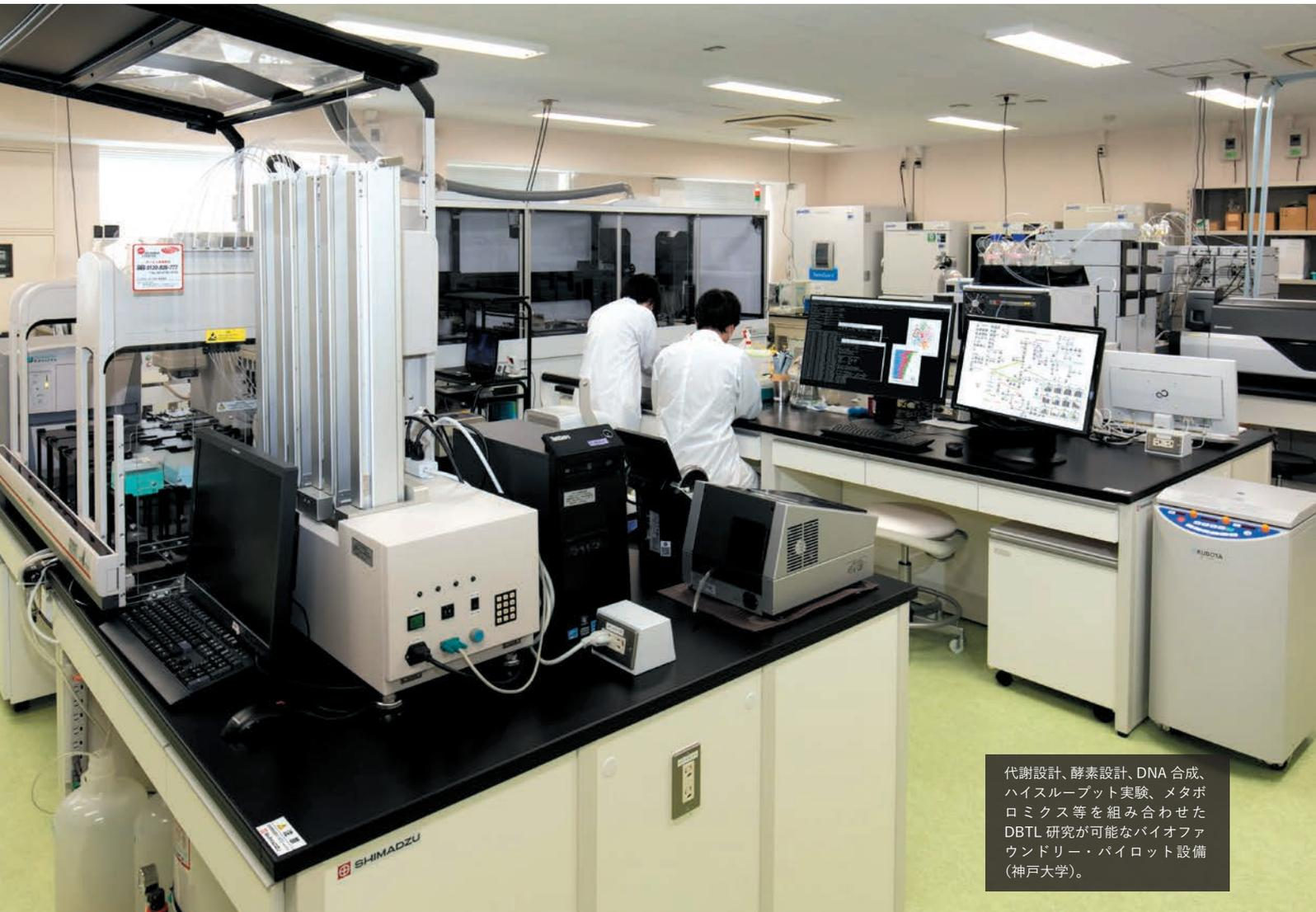
代謝設計、酵素設計、DNA 合成、ハイスループット実験、メタゲノミクス等を組み合わせた DBTL 研究が可能なバイオファウンドリー・パイロット設備 (神戸大学)。
